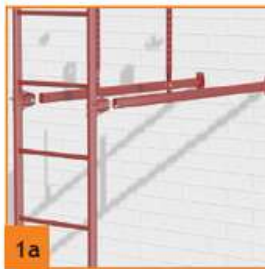
Установка подвесных кронштейнов с креплением к стропилам
