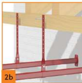
Соединение лестницы и переходного мостика с помощью L-образного кронштейна
