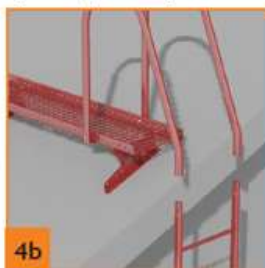
Соединение лестницы и переходного мостика с помощью L-образного кронштейна
